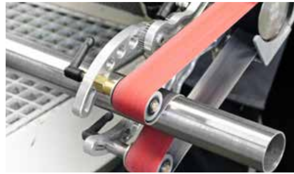
Broušení trubek a tyčí nakulato ručními stroji
