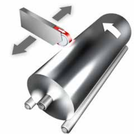
Průběžné broušení válců nakulato
