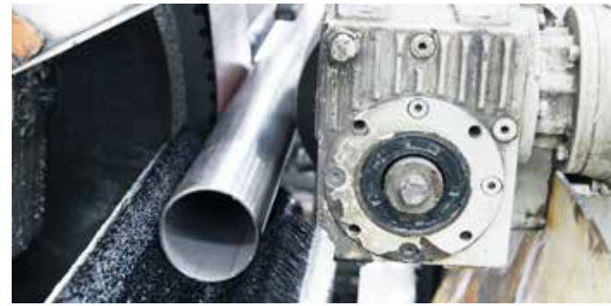
Broušení trubek a tyčí nakulato – bezhroté
