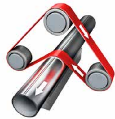
Broušení podélných švů svařovaných trubek
