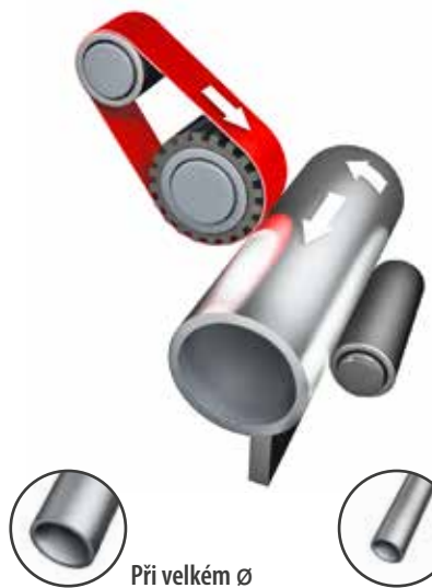
Broušení trubek a tyčí nakulato – bezhroté
