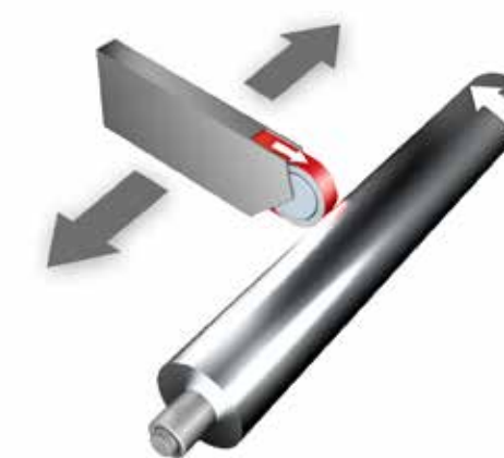
Broušení pístnic a válců nakulato, např. mezi hroty
