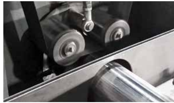
Broušení podélných švů svařovaných trubek
