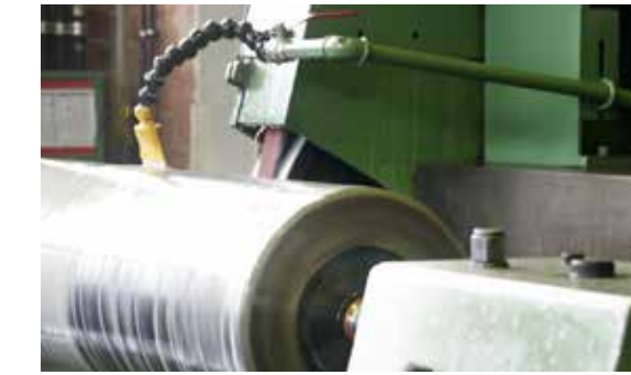
Broušení pístnic a válců nakulato, např. mezi hroty
