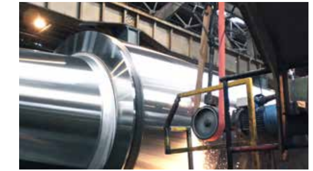
Průběžné broušení válců nakulato
