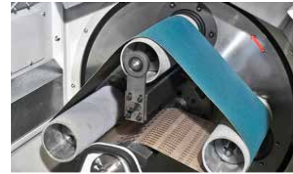
Odstraňování okují z drátů
