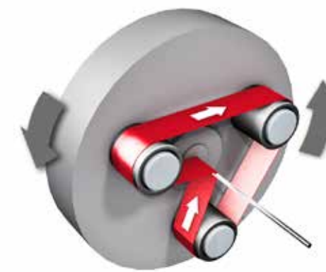
Odstraňování okují z drátů
